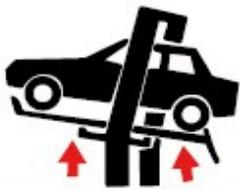
Não sobrecarregue o elevador! É proibido colocar objetos entre a sapata e o veículo!
