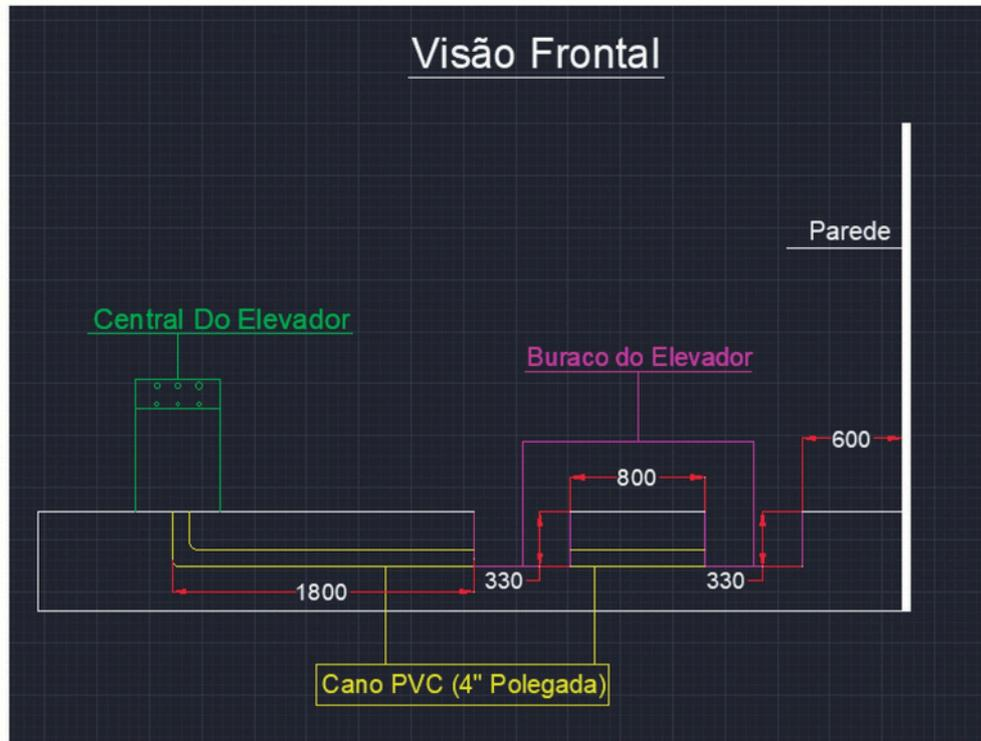
**FOTO TÉCNICA DA VALA PARA INSTALAÇÃO DO ELEVADOR**
