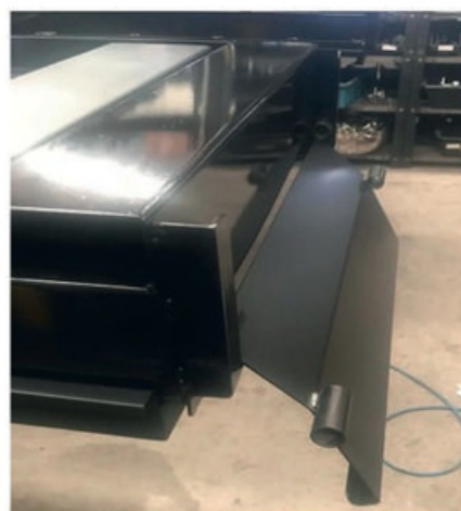
(FOTO 7: STOP DIANTEIRO DESTRAVADO)
