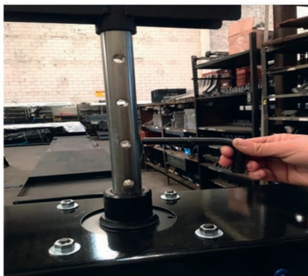
(FOTO 23: RETIRADA DO PINO TRAVA)
