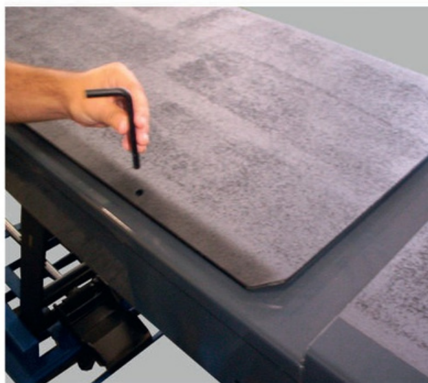
(FOTO 25: TRAVAMENTO DOS PRATOS)
