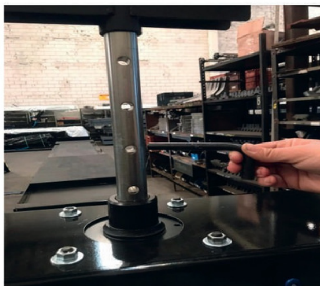
(FOTO 23: RETIRADA DO PINO TRAVA)
