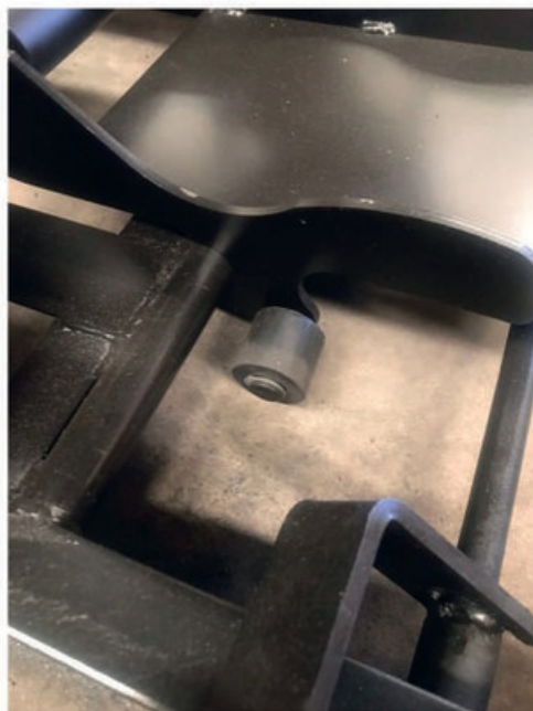
(FOTO 14: PEDAL NA POSIÇÃO E TRAVADO)
