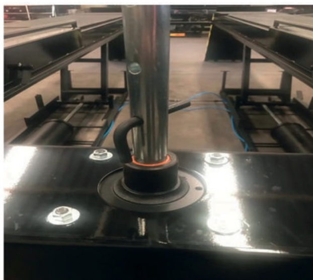
(FOTO 21: HASTE COM PINO APOIADO NA TAMPA)
