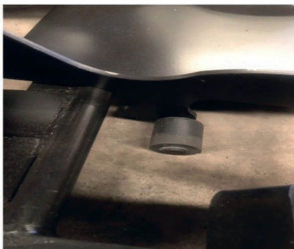
(FOTO 12: TRAVA NA POSIÇÃO PARA TRAVAMENTO)
