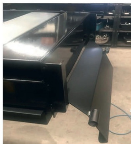
(FOTO 7: STOP DIANTEIRO DESTRAVADO)
