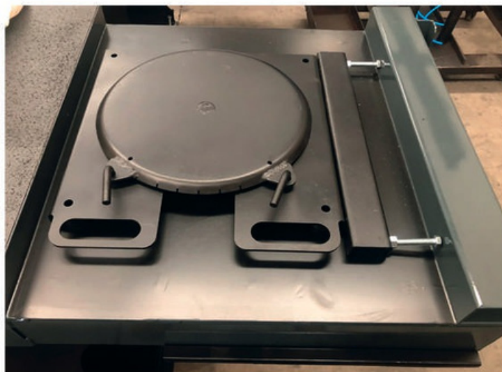
(FOTO 08: FIXAÇÃO DO PINO NO PRATO DIANTEIRO)
