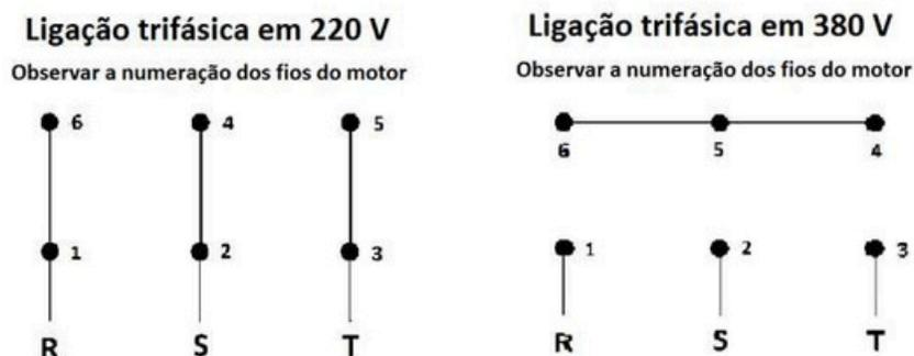
Atenção: Ao acionar o elevador, atente para as setas indicativas de subida e descida, fixadas na coluna do acionamento. Ao acionar a alavanca para cima, o carrinho móvel deverá subir, e ao acionar a alavanca para baixo, o conjunto móvel deverá descer. Caso os sentidos estejam divergentes, para motores trifásicos, é necessário inverter os cabos “R” e “S”. A rede elétrica deverá ser segura com disjuntor elétrico conforme quadro no item 09 deste manual.
