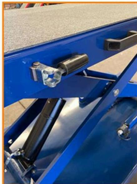
**A PLATAFORMA POSSUI ALÇAS E POSSIBILIDADE DE MOVIMENTAÇÃO LATERAL E TRAVAMENTO, CONFORME A NECESSIDADE.**
