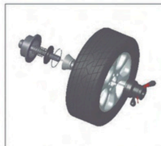
Eixo principal - mola (já foi instalado quando a unidade é fabricada), cone (ponta para fora) – roda Grampo rápido
