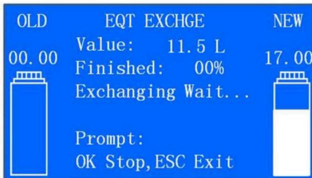
Se o armazenamento de óleo do novo tanque de óleo estiver em falta ou for menor do que a quantidade definida, o óleo da transmissão não poderá ser trocado, conforme mostrado a seguir; redefina a quantidade de troca ou complemente o novo óleo no novo tanque de óleo e, em seguida, realize a operação de troca de óleo.
