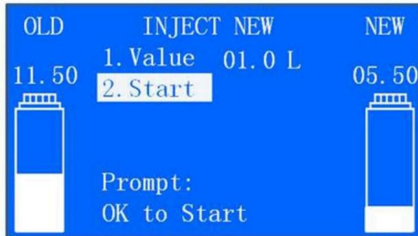
5.9. Pressione a tecla OK para iniciar a adição de óleo novo, pressione a tecla OK durante o processo de adição para fazer uma pausa e pressione ESC para retornar.
