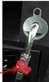
Válvula manual para descarga de óleo
