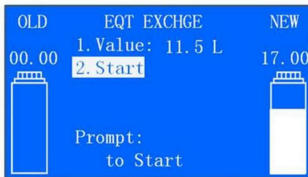
4.9. Pressione a tecla OK para iniciar a troca do óleo da transmissão; pressione a tecla OK para interromper a troca, se necessário; pressione a tecla OK novamente para continuar a troca; pressione a tecla Esc para interromper a troca e sair.
