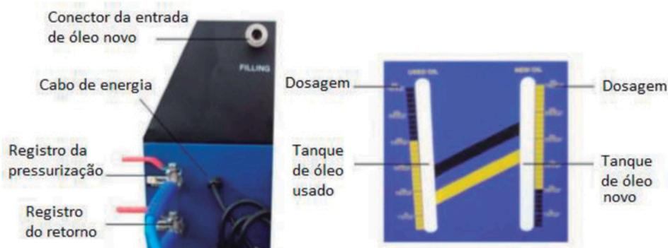
Quando os tanques estão cheios, os fluidos podem ser vistos através da janela dos tanques na parte frontal da máquina.
