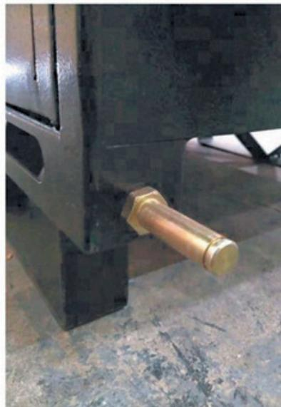
Em seguida instale a roda no eixo e coloque a trava da roda.
