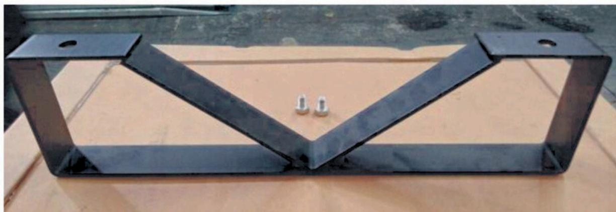
Após concluir o processo retire a estrutura de ferro para transporte da frente da máquina, que está fixada por 3 parafusos como indicado na foto abaixo.
