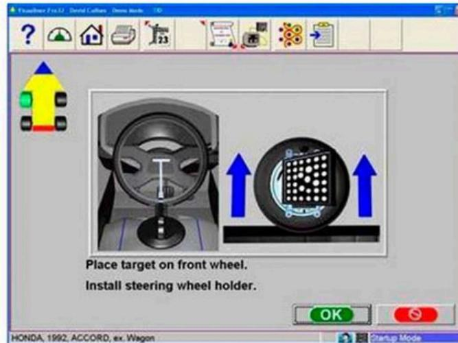
Passo 4. Coloque o Alvo na Roda Dianteira
