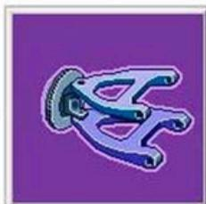
Primeiro, uma tela instrui o operador a aplicar o depressor do pedal do freio (importante) e remover os pinos de trava das plataformas giratórias. Selecione OK.
