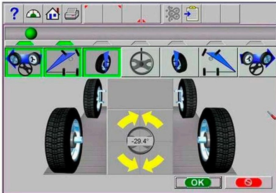
17. Continue girando a roda o máximo possível até a posição de travamento total deste lado. Segure firme até que a caixa verde/ícone deprimido apareça e o sinal de parada desapareça, indicando que a medição foi concluída.
