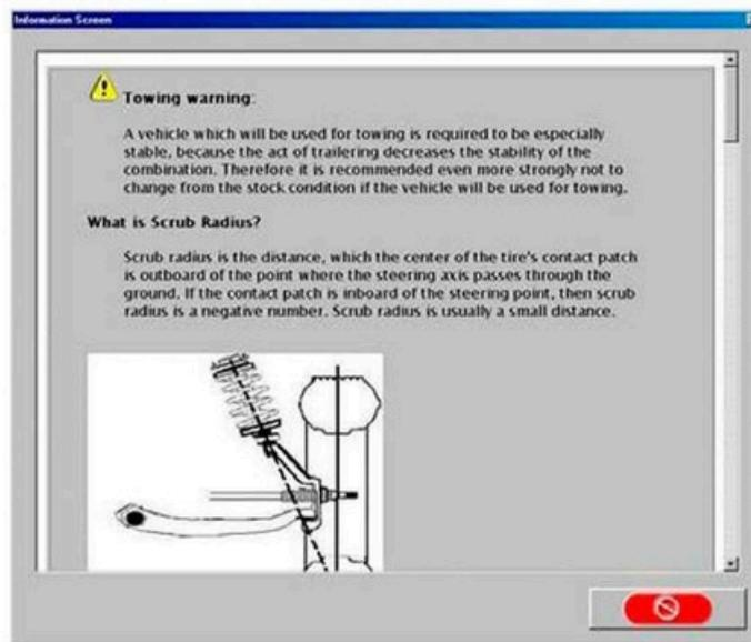
Mudanças de direção e suspensão que podem afetar adversamente a condução, o manuseio e o desgaste dos pneus são: kits de elevação, rebaixamento, configurações de alinhamento fora da tolerância do fabricante, buchas de suspensão, amortecedores (amortecedores), fusos personalizados, braços de ligação, piso do pneu ou incompatibilidade de composto, pneu incompatibilidade de tamanho, juntas esféricas desgastadas ou outros componentes de articulação desgastados ou tortos.
