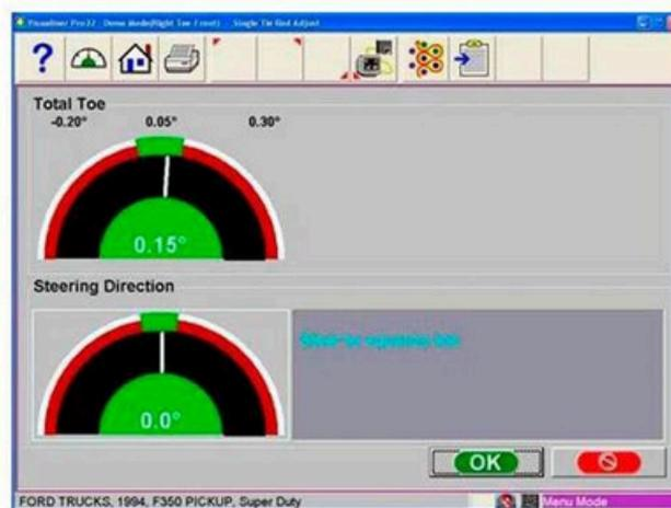
2. Ajuste o tirante único para as especificações toe toe enquanto observa o medidor superior.
