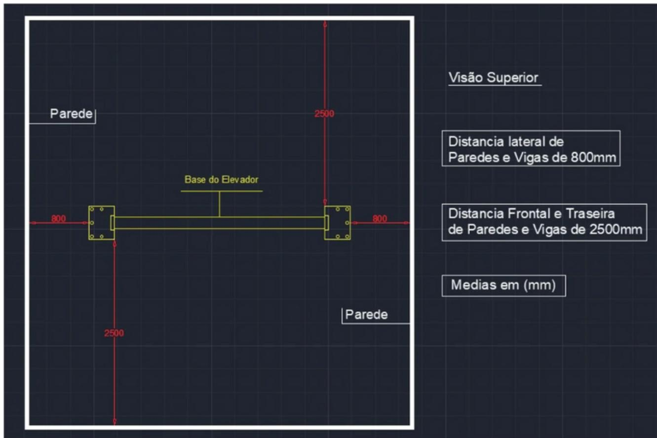
**DESENHO TÉCNICO DA SAPATA DE CONCRETO**
