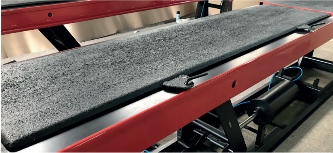
(FOTO 09: FIXAÇÃO DO PINO NO PRATO TRASEIRO)
