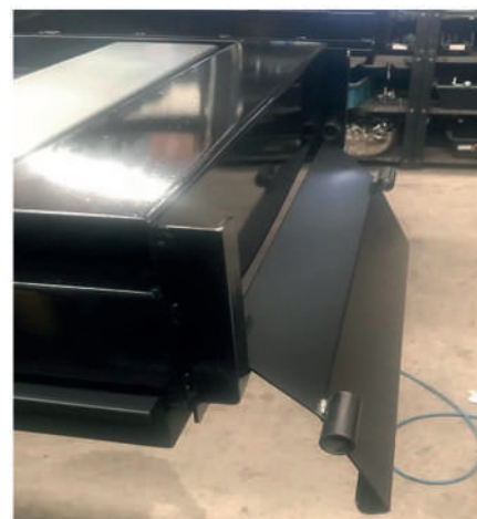
(FOTO 7: STOP DIANTEIRO DESTRAVADO)
