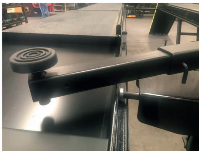
(FOTO 17: BARRA TRAVADA NA ÚLTIMA POSIÇÃO DE SEGURANÇA)
