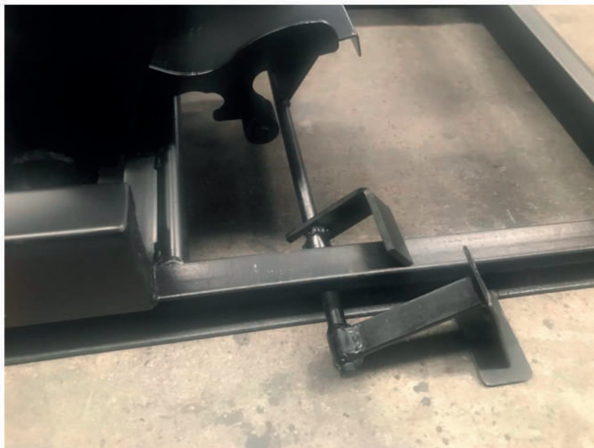
(FOTO 28: POSIÇÃO DO PEDAL DESTRAVADO)
