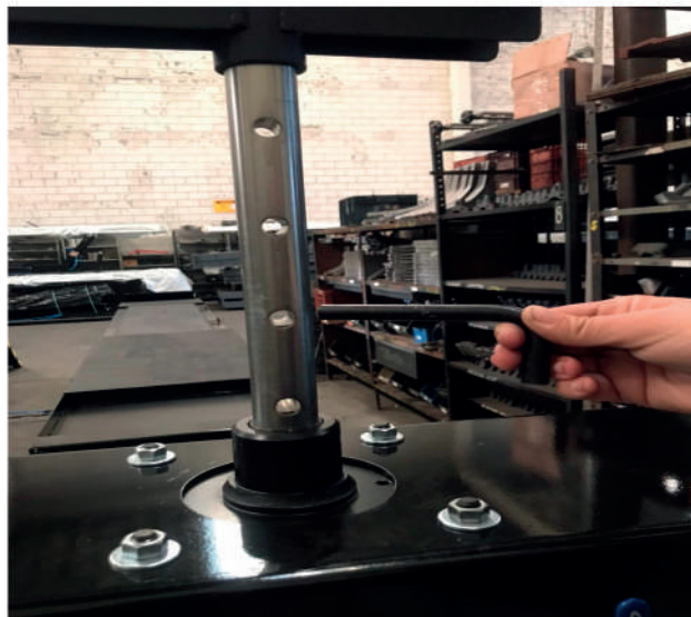
(FOTO 23: RETIRADA DO PINO TRAVA)
