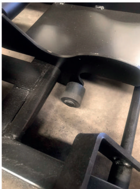
(FOTO 14: PEDAL NA POSIÇÃO E TRAVADO)
