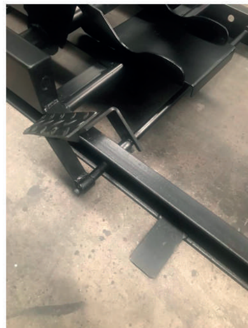
(FOTO 15: VISÃO GERAL DA TRAVA DE SEGURANÇA JÁ TRAVADA)
