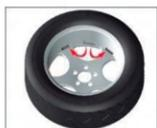
A função de colagem escondida do contrapeso pode cortar a posição de desbalanceamento em duas partes, e fazer com que estas duas novas posições se escondam atrás do raio. Esta função pode manter uma boa sensação estética do aro.
